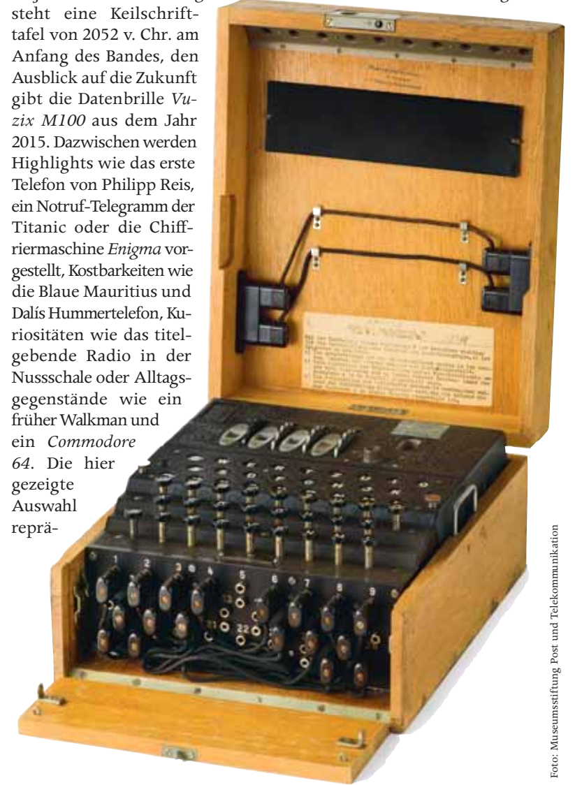
Chiffriermaschine Enigma M4 mit vier Walzen in Marineausführung, 1944
